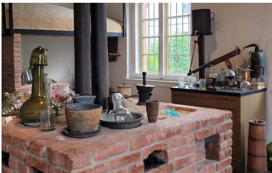
Abb. 2: Das «alte Labor», vorne der Ofen, im Hintergrund eine Destillation mit original Liebigkühler
